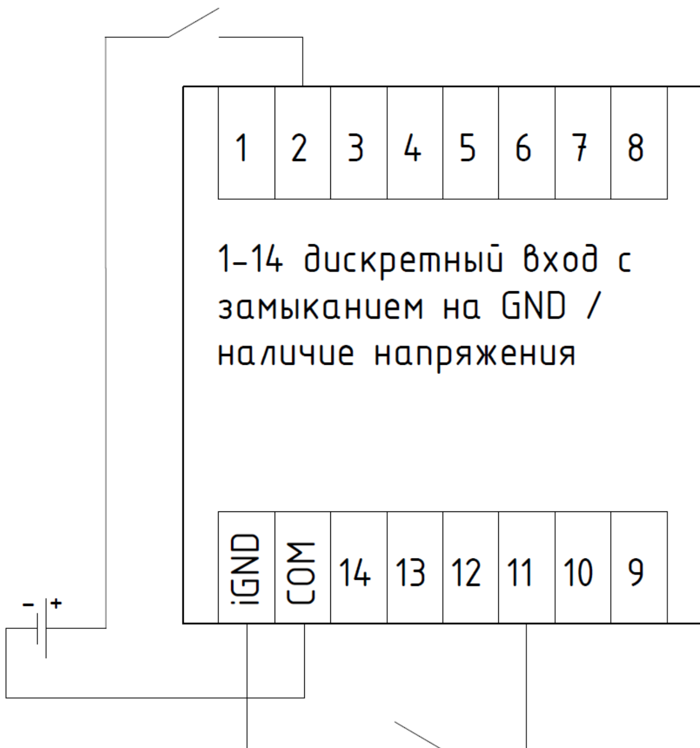
Рисунок 1.71 - Электрическая схема подключения модуля расширения EMD
