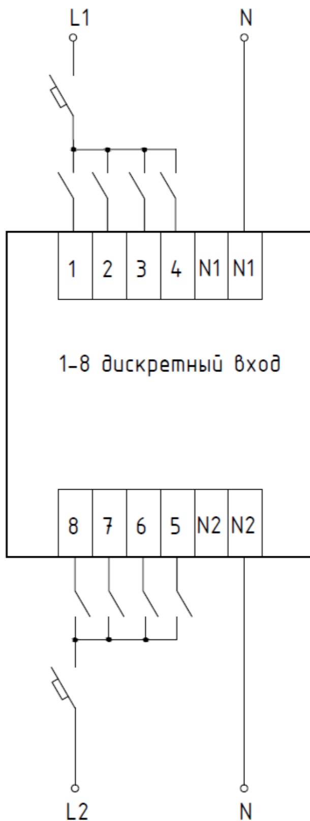
Рисунок 1.69 - Электрическая схема подключения модуля расширения EMD
